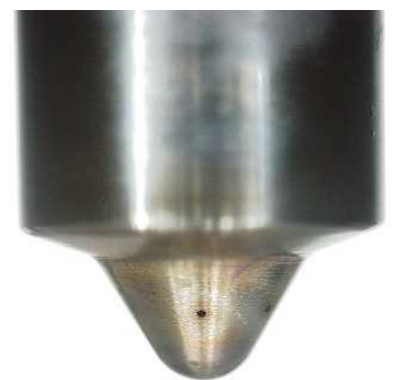
洗浄後の噴孔部
